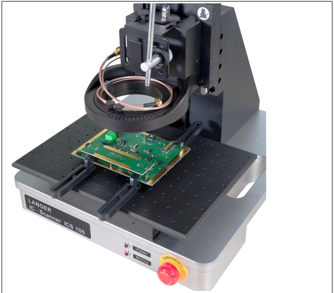
Bild 65: Befestigungsbeispiel mit Krallen claw 02
